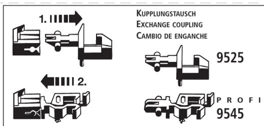
Beim Kupplungsaustausch (siehe 3) von unten so auf das Drehgestell drücken, dass die Kupplungsdeichsel fixiert wird. Danach die Kupplung vorsichtig einstecken bzw. herausziehen.
